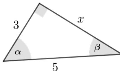
$$\sin(\beta) = \frac{\text{côté opposé}}{\text{hypoténuse}} = \frac{3}{5} \quad \text{La touche arcsin de la calculatrice permet de calculer } \beta \approx 36,87^\circ.$$
